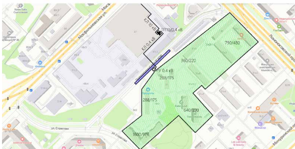
План местности. 640/390 – число жителей/число автомобилей во владении. Синий сектор – парковочная зона для электротранспорта и кабельный туннель 0,4 кВ
